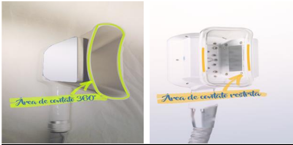
Figura 2: Manopla 360° e manopla convencional
